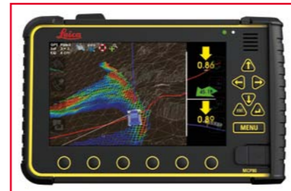
Zobrazenie nameraných údajov priamo na displeji ovládacieho panela v kabíne
