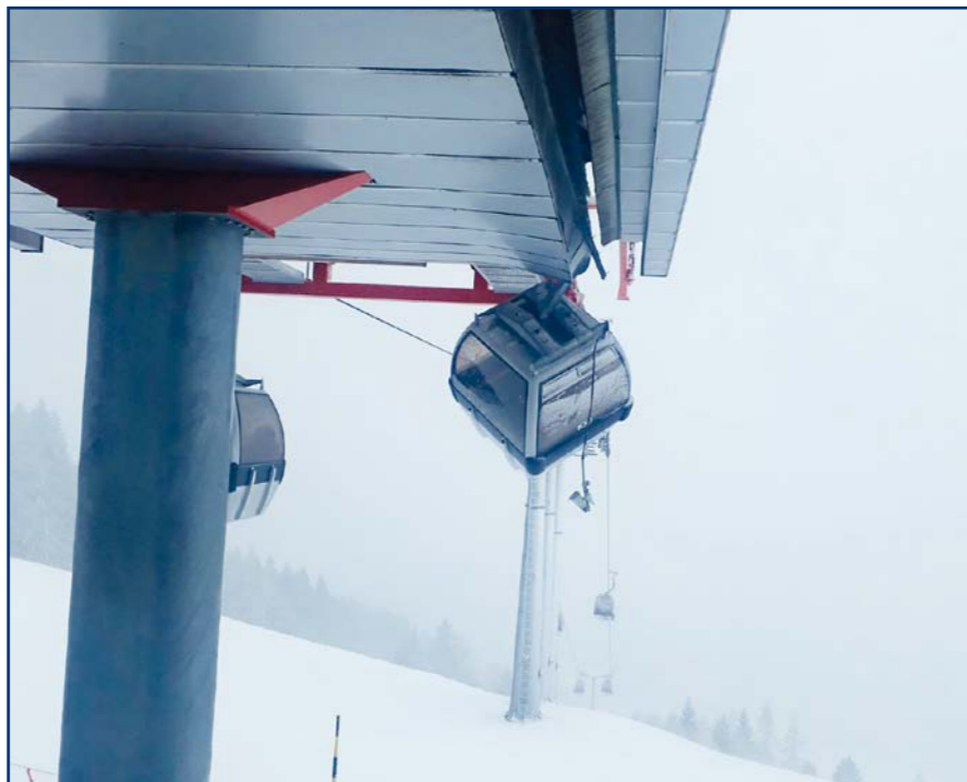
Kitzbühel, Hornbahn I, 3. ledna 2018: V důsledku nečekaně silného poryvu větru byla kabinka jedoucí směrem nahoru natlačena do vjezdových svodidel mezistanice a následně se v této stanici zaklínila. Došlo k mechanickému poškození mezistanice a totální škodě na kabině, kterou bylo nutné stáhnout z provozu. (Foto: Bergbahn AG Kitzbühel/Florian Wörgetter)
