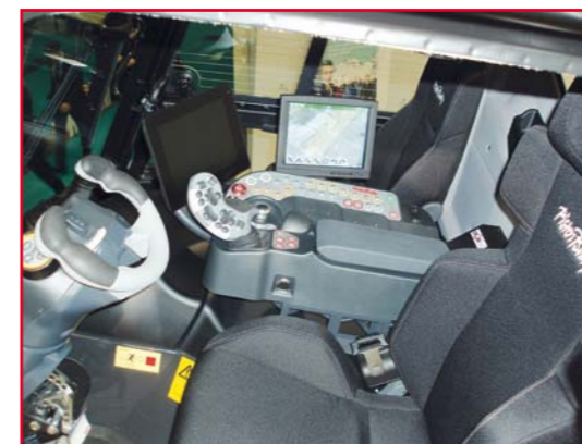
Nové pracovné miesto vodiča PB100 4F s inštalovaným systémom SNOWsat
