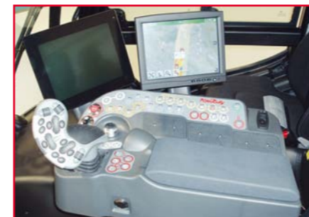
Detail nového usporiadania ovládacích prvkov
