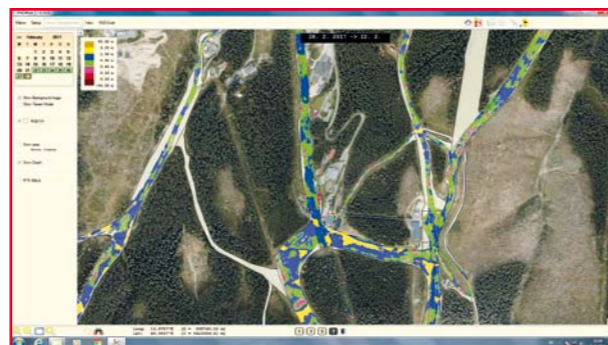
Zobrazenie severnej časti Chopku – rozloženie hrúbky snehovej vrstvy po prejazde vozidlami PB 600 W s inštalovaným systémom SNOWsat Variant 3.
