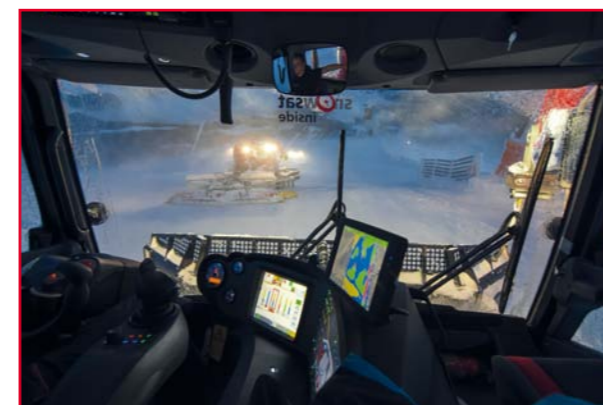
Pracovisko vodiča vo vozidle s inštalovaným systémom SNOWsat Variant 3.
