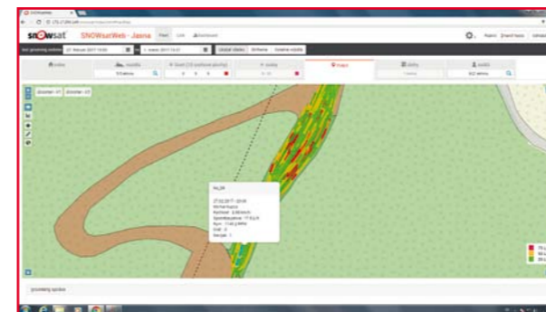
Vyhodnotenie konkrétneho vozidla – poloha, rýchlosť, spotreba, otáčky motora, použitie prídavného zariadenia.
