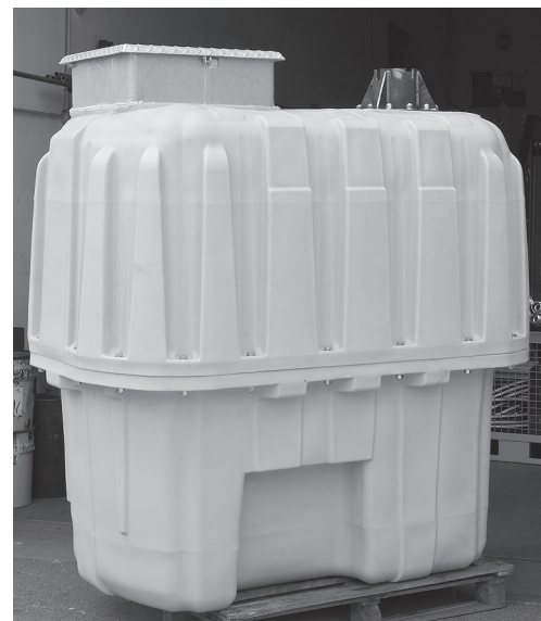
Malá vlastná hmotnosť a jednoduchá montáž – týmto presvedčajú PE-šachty. PE-šachta bola vyrobená odstredivým odlieváním a projektovaná podľa „sandwich“ princípu
