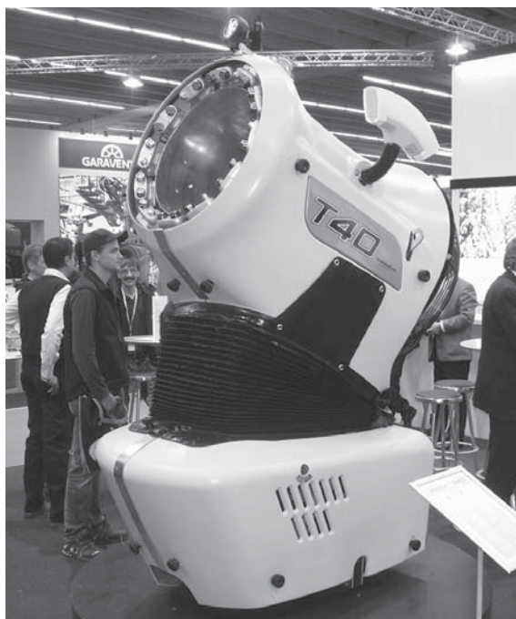
Zasnežovací kanón T-40 - Technoalpin
