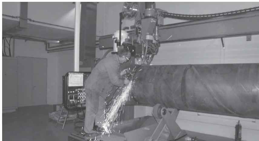
Výroba v novom závode sa už začala – brúsenie pred zvaraním
