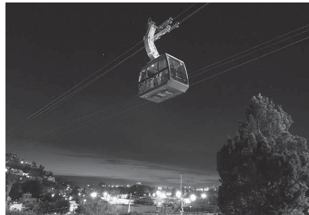
Nočný záber na kabínkovú lanovú dráhu v mexickom Durangu s dvoma kabínami pre 25 osôb
