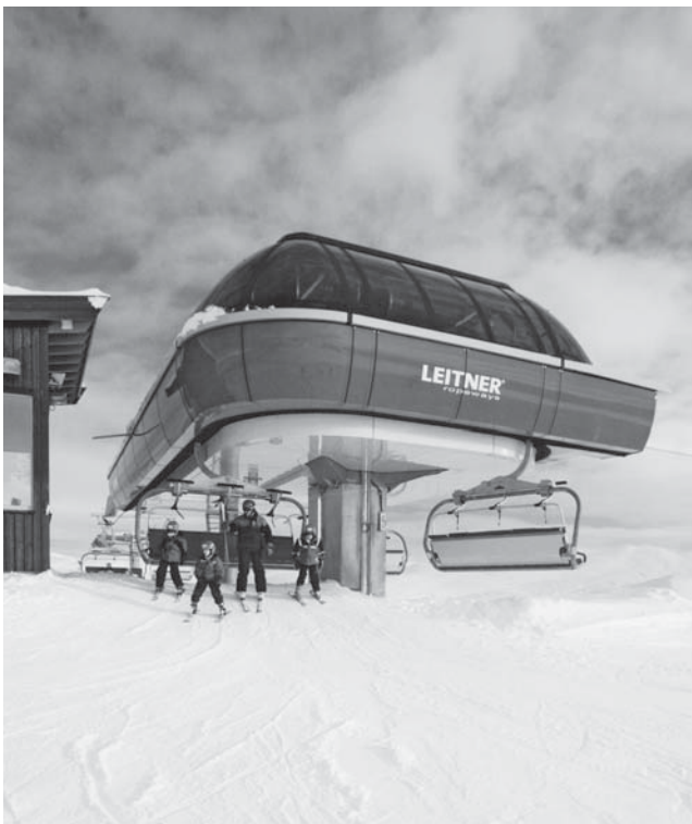
■ Odpojiteľná 6-miestna lanová dráha CD6 Myrkdalsekspressen inštalovaná v stredisku Voss Fjellandsby, Nórsko. Technické údaje: dĺžka trate 1 513 m, prevýšenie 399 m, prepravná kapacita 3 037 os./h, výkon 531 kW
