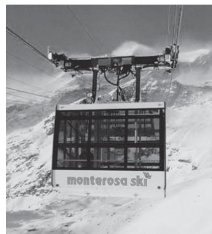
■ Kabínová lanovka Monterosa – systém Funifor je mimoriadne stabilný vo vetre
