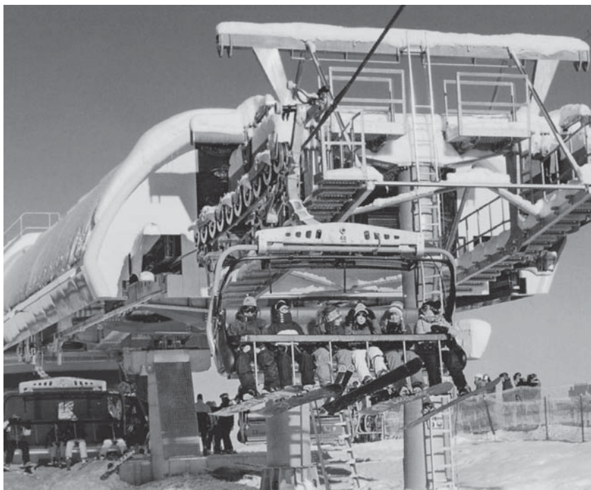
■ Strediská Imberg-Bahnen a Ski-Arena Steibis sú lyžiarskym rajom pre rodiny a aktívnych dovolenkárov. Údolná stanica lanovky Fluhexpress 6-CLD-B-S
