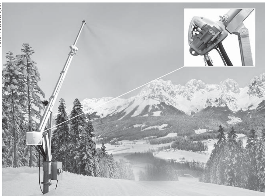
■ Nadzemný ventilový blok sa pripevní prírubou na rúru snežnej tyče
