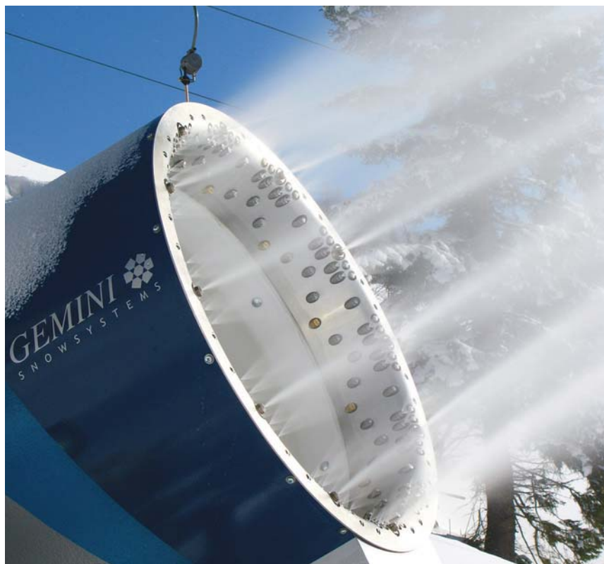
■ Gemini® snežné delá S20A Perinbaba prispôsobujú veľkosť snehových kryštálov teplote ovzdušia. V hraničnej oblasti okolo nuly produkujú cez jemné trysky prvého okruhu drobné, rýchlo mrznúce kvapôčky o priemere len 0,070 mm. Pri -10^{\circ}\text{C} sa kvapky štvrtého okruhu o priemere až 0,600 mm menia na mohutné kryštály, tvoriace veľkú masu snehu
