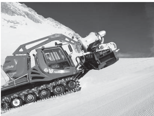
■ Jednoduchá preprava snehových kanónov nielen firmy TechnoAlpin na radlici PistenBully
