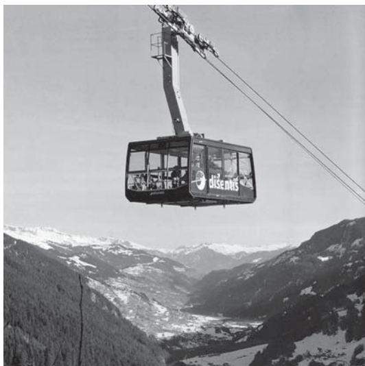
■ Kyvadlová lanovka Disentis je prvou kyvadlovou lanovkou v Švajčiarsku certifikovaná podľa EN, kyvadlovou lanovkou bez koľajovej brzdy
