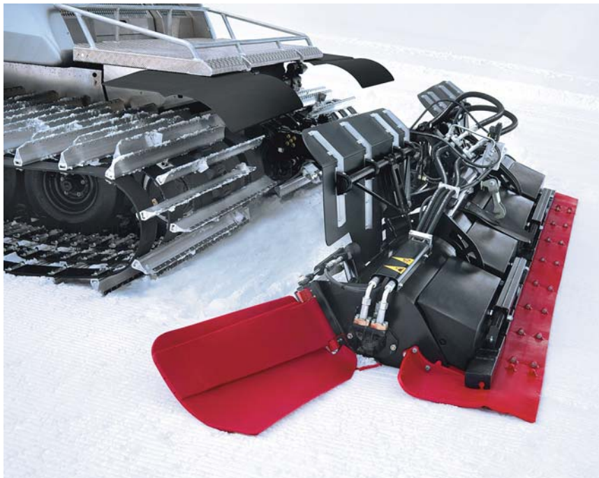
■ Osvedčený v novom dizajne: power fréza s optimálnou ochranou snehu
