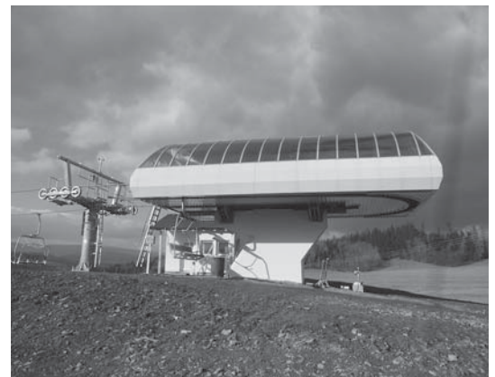
Poháňacia stanica s napínaním umiestnená v hornej časti lanovej dráhy (ilustračný záber)
