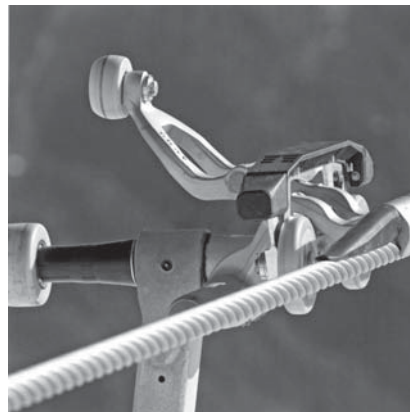
■ V strediskách, kde sú v prevádzke lanovky Doppelmayr s torznými tyčami, vedúci prevádzky lanoviek sa vyslovujú veľmi pochvalne o spoľahlivosti a ľahkej údržbe torzných tyčových úchyty
