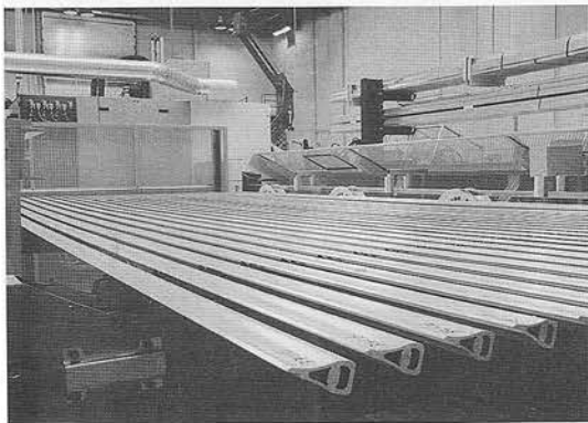
■ Lišty pásov sú narezané a opracované s presnosťou na tisíciny milimetrov
