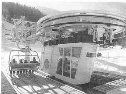
■ Údolná stanica 4-miestnej sedačkovj lanovky Doppelmayr 4CLF
